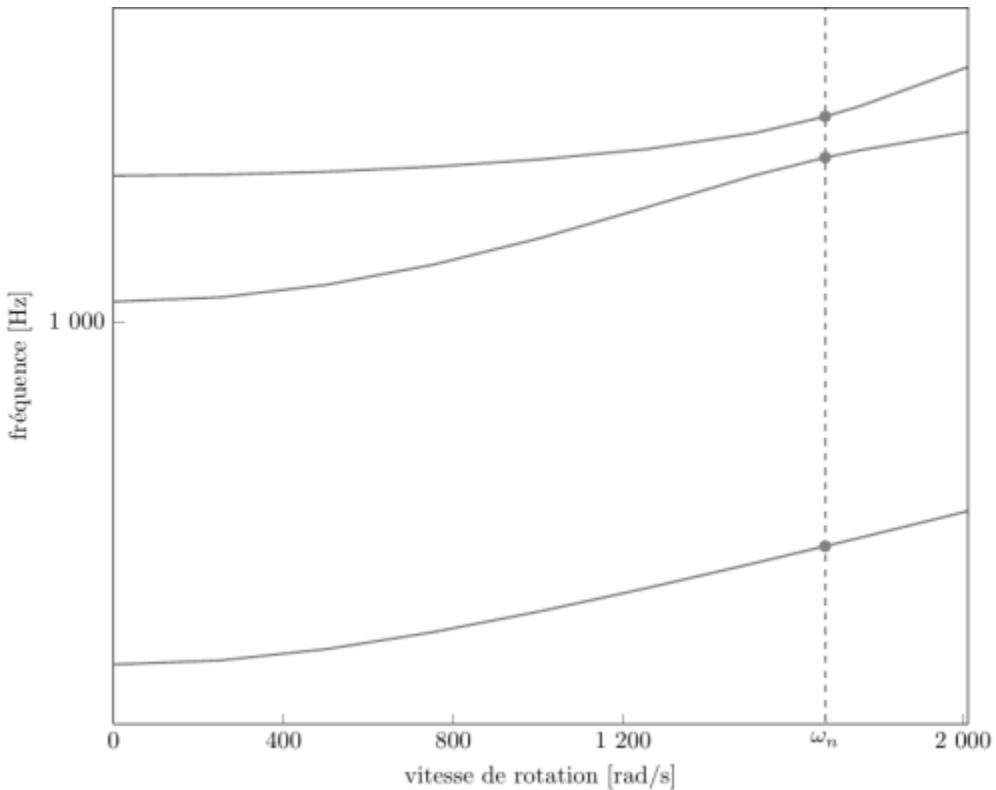
diagramme de Campbell calculé avec une précharge centrifuge linéaire, noeuds du pied d'aube encastrés (vitesse nominale  $\omega_n = 1\,675,52$  rad/s)
