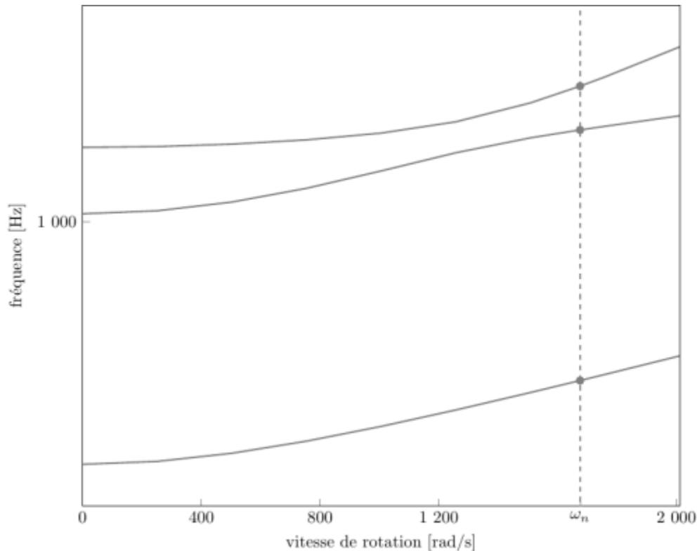
diagramme de Campbell calculé avec une précharge centrifuge linéaire, noeuds du pied d'aube encastrés (vitesse nominale  $\omega_n = 1\,675,51$  rad/s)
