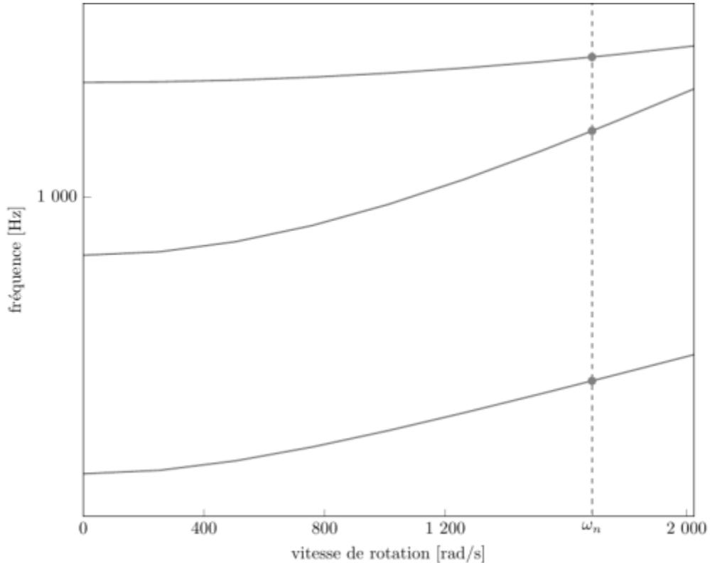
diagramme de Campbell calculé avec une précharge centrifuge linéaire, noeuds du pied d'aube encastrés (vitesse nominale  $\omega_n = 1\,686 \text{ rad/s}$ )
