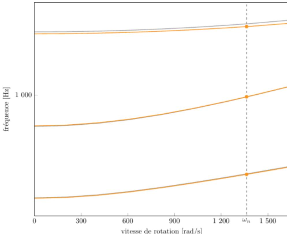
diagramme de Campbell calculé avec une précharge centrifuge linéaire, noeuds du pied d'aube encastrés (vitesse nominale  $\omega_n = 1\ 363,45$  rad/s),
