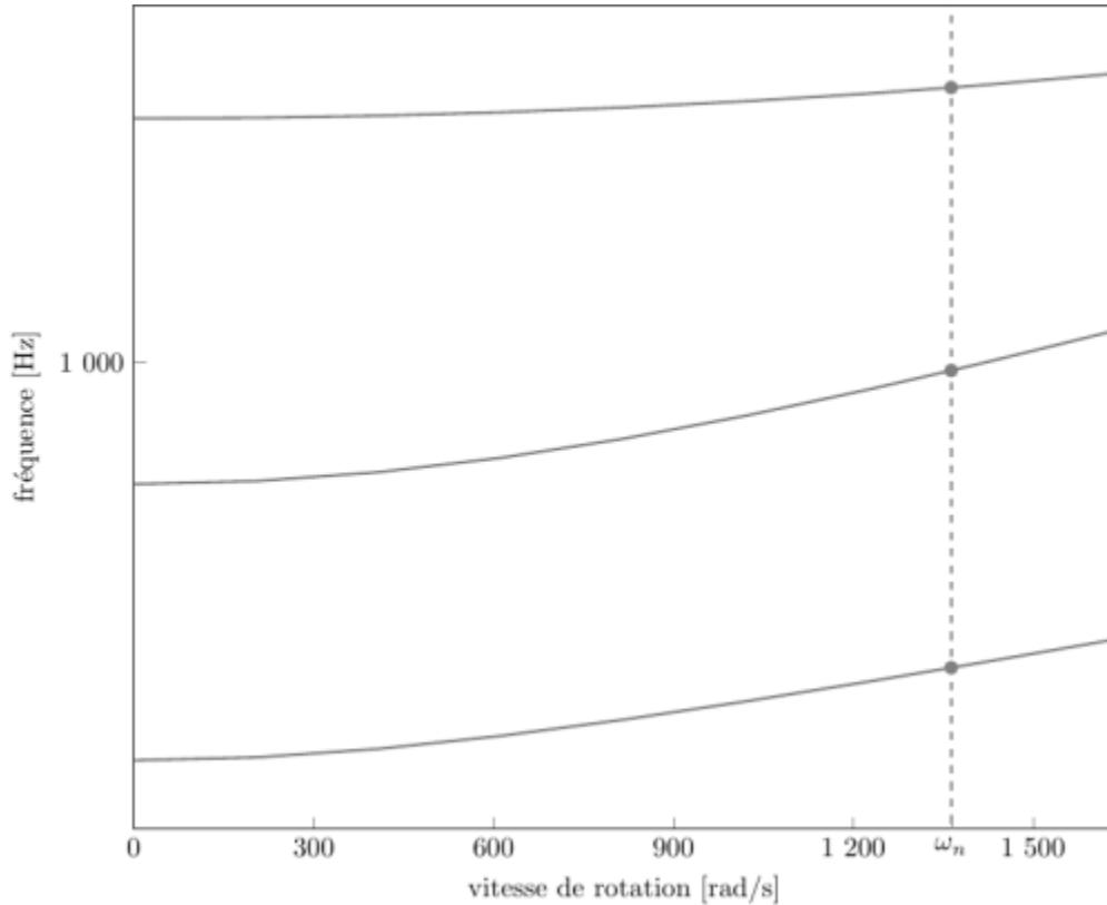
diagramme de Campbell calculé avec une précharge centrifuge linéaire, noeuds du pied d'aube encastrés (vitesse nominale  $\omega_n = 1\ 363,45 \text{ rad/s}$ )
