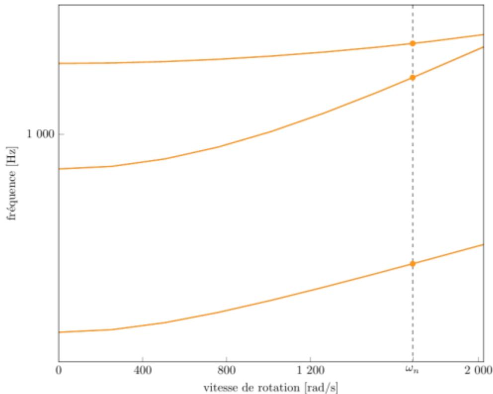
diagramme de Campbell calculé avec une précharge centrifuge linéaire, noeuds du pied d'aube encastés (vitesse nominale  $\omega_n = 1 686$  rad/s),
