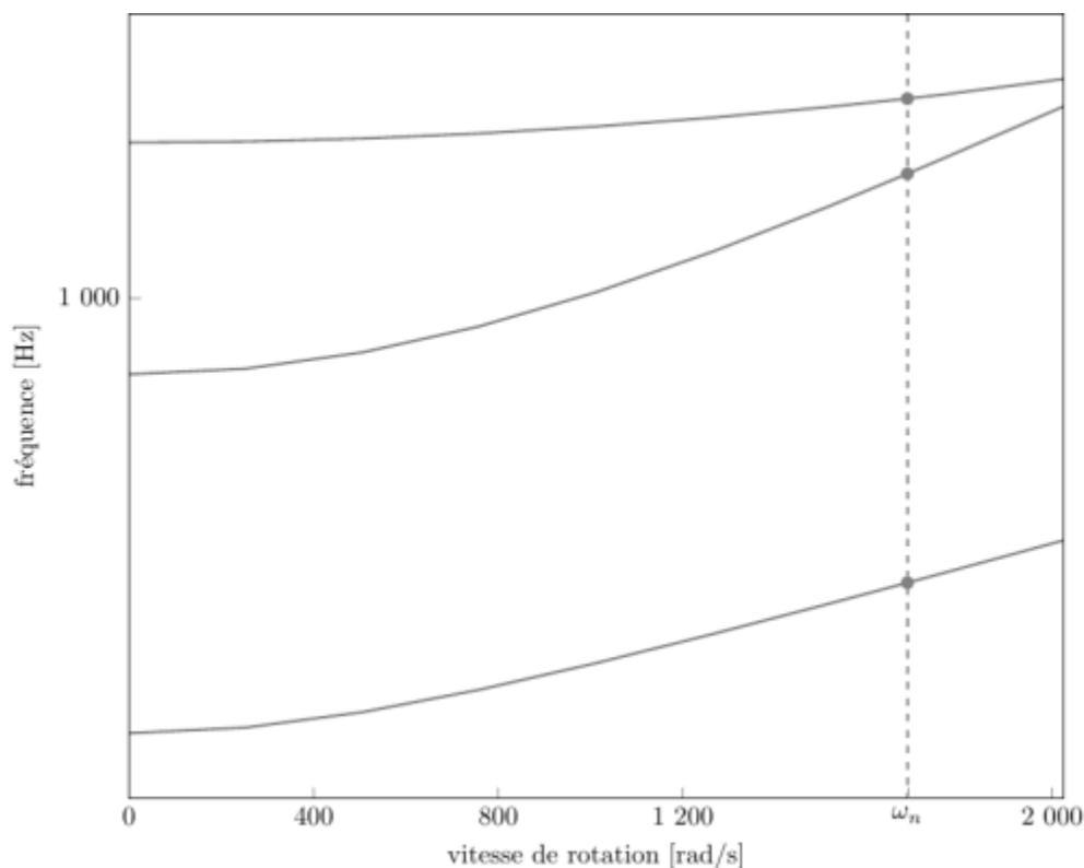
diagramme de Campbell calculé avec une précharge centrifuge linéaire, noeuds du pied d'aube encastres (vitesse nominale  $\omega_n = 1\,686$  rad/s)
