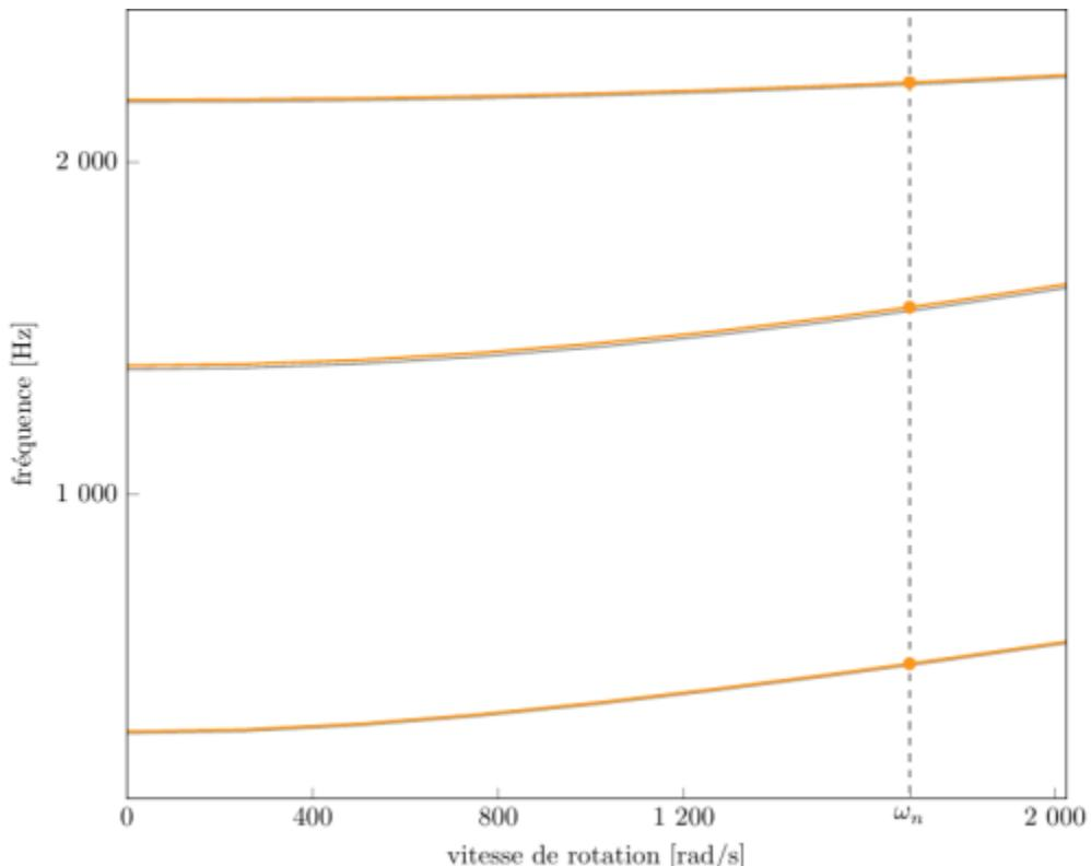
diagramme de Campbell calculé avec une précharge centrifuge linéaire, noeuds du pied d'aube encastrés (vitesse nominale  $\omega_n = 1\,686$  rad/s),
