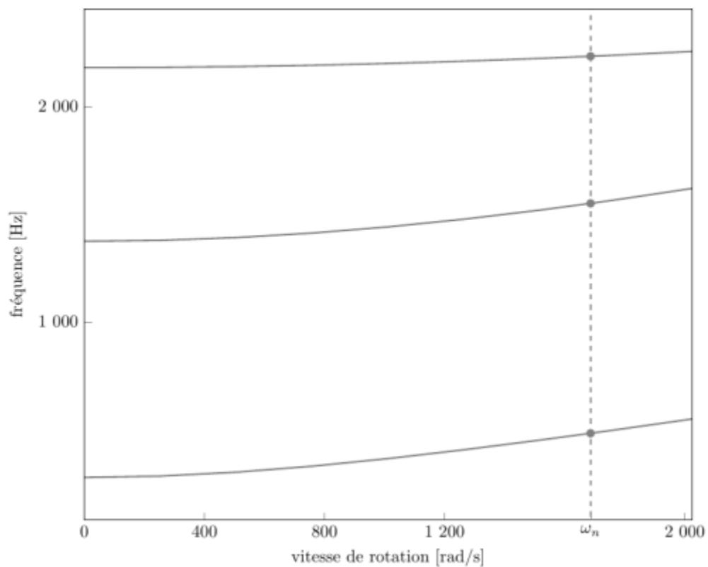
diagramme de Campbell calculé avec une précharge centrifuge linéaire, noeuds du pied d'aube encastrés (vitesse nominale  $\omega_n = 1\,686$  rad/s)
