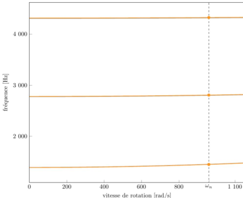
diagramme de Campbell calculé avec une précharge centrifuge linéaire, noeuds du pied d'aube encastrés (vitesse nominale  $\omega_n = 960,28$  rad/s),
