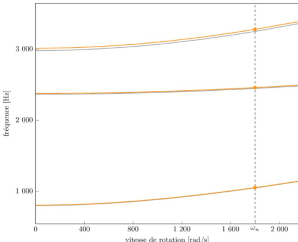
diagramme de Campbell calculé avec une précharge centrifuge linéaire, noeuds du pied d'aube encastrés (vitesse nominale  $\omega_n = 1800$  rad/s),
