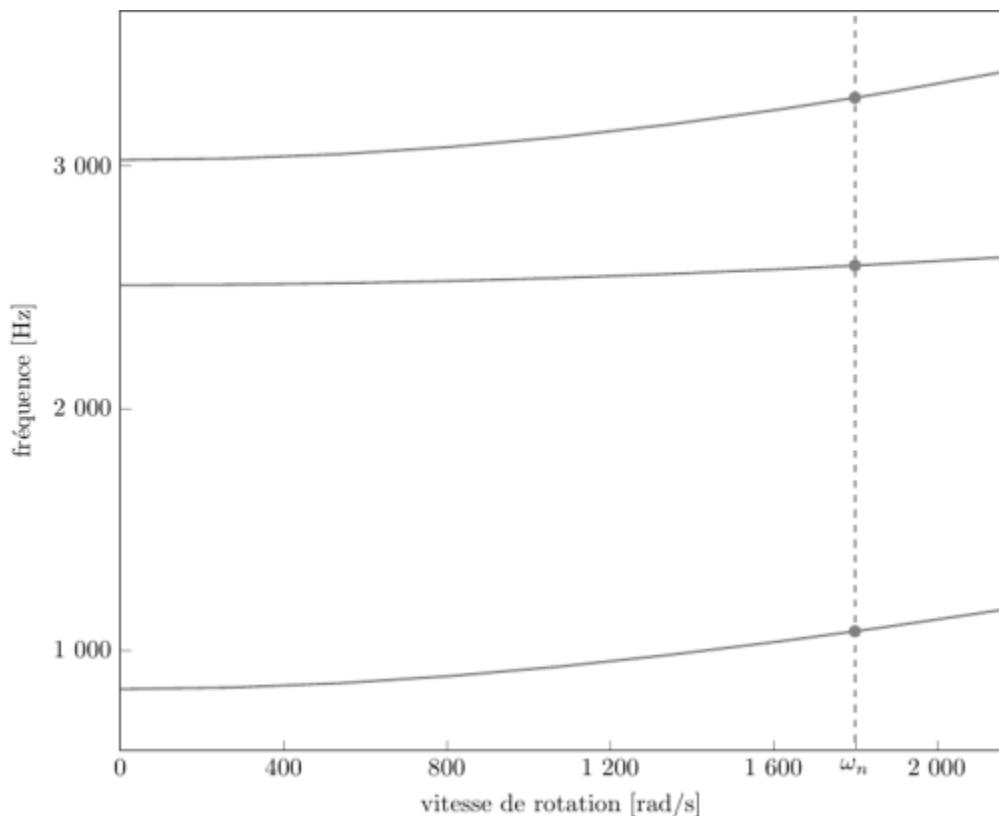
diagramme de Campbell calculé avec une précharge centrifuge linéaire, noeuds du pied d'aube encastrés (vitesse nominale  $\omega_n = 1\,800 \text{ rad/s}$ )
