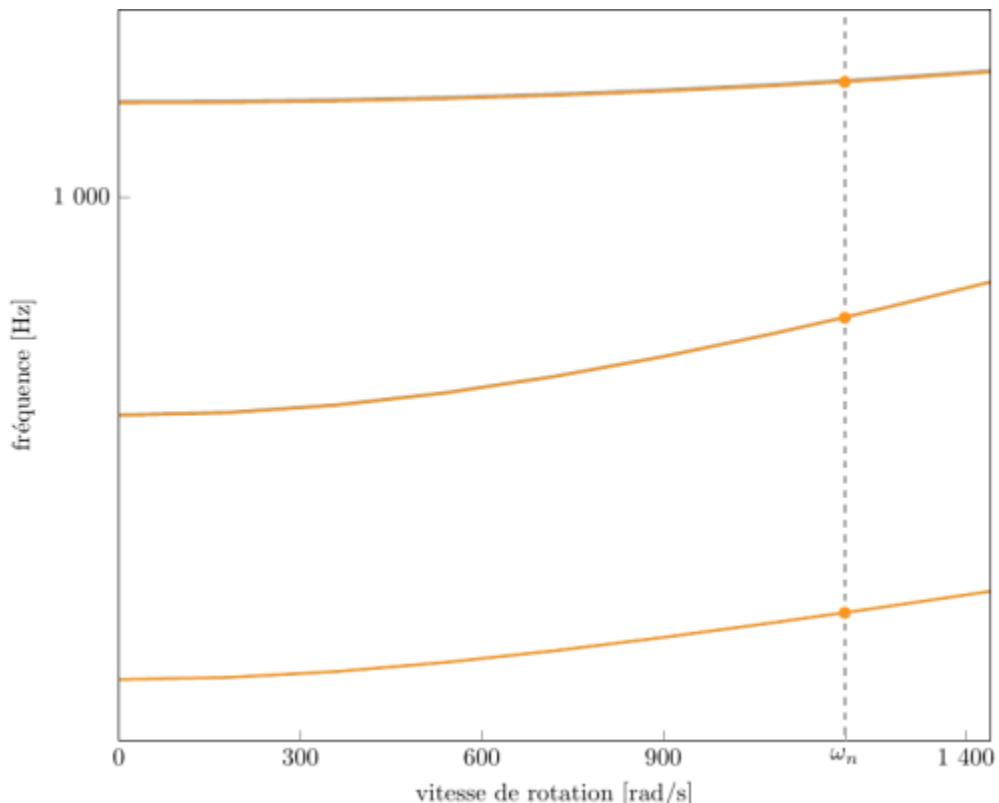
diagramme de Campbell calculé avec une précharge centrifuge linéaire, noeuds du pied d'aube encastrés (vitesse nominale  $\omega_n = 1\ 200 \text{ rad/s}$ ),
