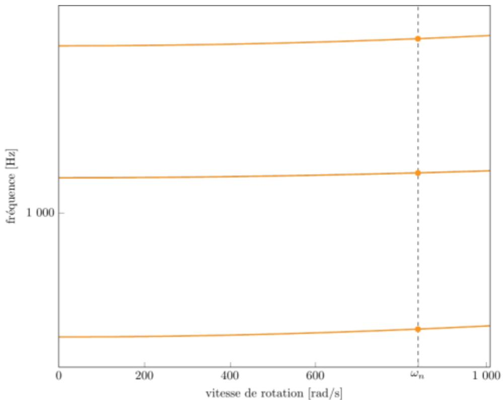
diagramme de Campbell calculé avec une précharge centrifuge linéaire, noeuds du pied d'aube encastrés (vitesse nominale  $\omega_n = 839,85$  rad/s),
