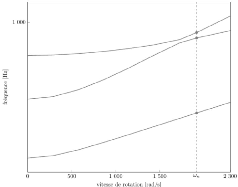
diagramme de Campbell calculé avec une précharge centrifuge linéaire, noeuds du pied d'aube encastrés (vitesse nominale  $\omega_n = 1\,918,66$  rad/s)
