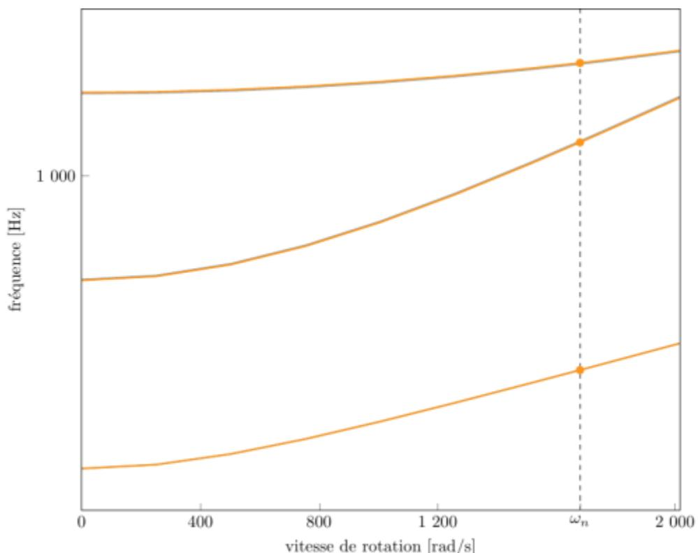
diagramme de Campbell calculé avec une précharge centrifuge linéaire, noeuds du pied d'aube encastrés (vitesse nominale  $\omega_n = 1\,679,94$  rad/s),
