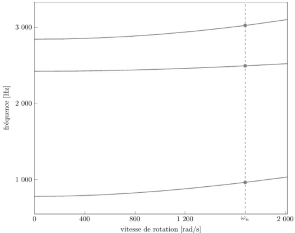
diagramme de Campbell calculé avec une précharge centrifuge linéaire, noeuds du pied d'aube encastrés (vitesse nominale  $\omega_n = 1\,680$  rad/s)
